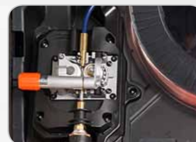
Modele Kempact 181/251 posiadają 2-rolkowy mechanizm podający GT02.
