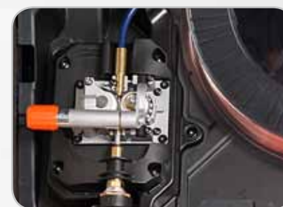
Modele Kempact 181/251 posiadają 2-rolkowy mechanizm podający GT02.
