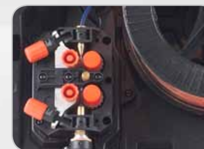
Modele Kempact 253/323 posiadają 4-rolkowy mechanizm podający DuraTorque.
