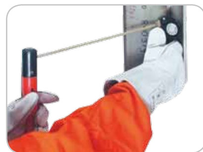
Aby użyć bezprzewodowego zdalnego sterowania R11-T, wystarczy dotknąć elektrody
